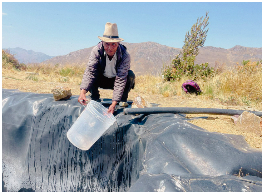
Foto: Florentín Polo, agricultor investigador de Ullucurán, realizando el aforo de un caudal.
