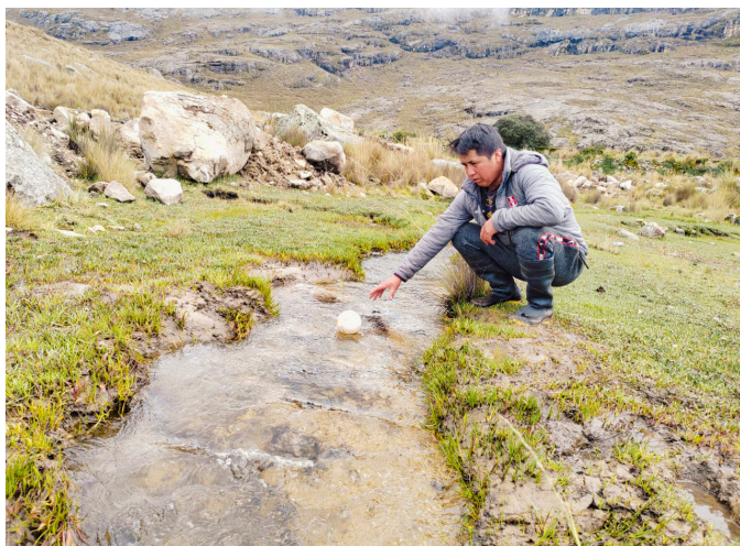
Foto: Richard Rondán, agricultor investigador y presidente de la JASS de Mallacayán, realizando la medición por el método del flotador.
