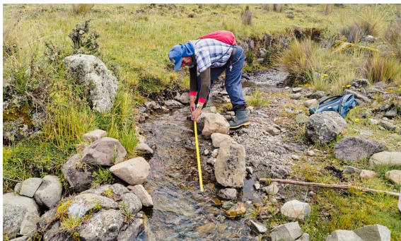
Foto: Eleuterio Figueroa, agricultor investigador de la Comunidad Campesina de Santa Cruz, acondicionando el área para aplicar el aforo por el método del flotador.
